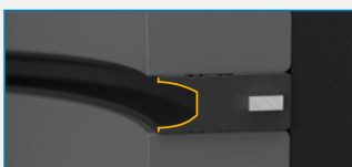
Detalle de junta bilabial “J-BIL” con presión. Detail of the “J-Bil” o-ring with internal pressure.
